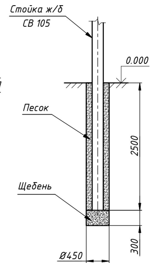
1. Стойки СТП устанавливаются в сверленные котлованы на подушки из щебня. Пазухи между стойками и стенками котлованов заполняются крупнозернистым песком с тщательным уплотнением.
